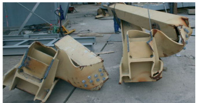
Bild 6. Auflagerknoten des Fachwerkträgers nach dem Schadensfall
